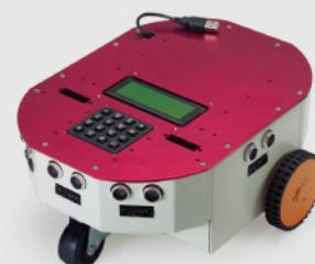
輪型多功能整合自走車套件，包含兩組直流馬達，鋁合金框架，超音波及紅外線感測模組。使用innoBASIC™系統，可以輕鬆增加其他不同功能的模組，達到更複雜與多變的應用。同時具備與個人電腦溝通的能力，當需要由電腦負責如影像辨識等大量運算，可以整合innoBASIC™(VB)系統與電腦平台，提供更複雜的機器人相關研究。
