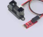
IRF150是利用SHARP GP2Y0A02YK反射式紅外線偵測元件，來偵測從平面反射回來的類比訊號，並可透過A2P Converter轉換成脈波寬度訊號輸出，可測量約20-150cm之距離，使用者可依據不同環境進行調整。
