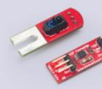
IRF6是利用TCRT5000反射式紅外線偵測元件，來偵測從平面反射回來的類比訊號，並可透過A2P Converter轉換成脈波寬度訊號輸出，可測量約0-6cm之距離，使用者可依據不同環境進行調整。
