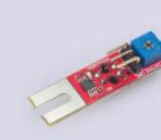
IRD是利用TCRT5000反射式紅外線偵測元件，來偵測從平面反射回來的訊號，並透過比較器將類比訊號轉換成0或1的訊號輸出，模組上的可變電阻可依不同平面顏色特性而調整成不同感度，使用者可依據不同環境進行調整。
