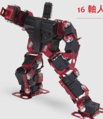
16軸人形機器人套件，以 SC16 為控制核心，鋁合金機身框架，搭配16個金屬齒輪伺服機，附有組裝手冊及範例程式。使用 innoBASIC™ (VB) 語言撰寫程式，可搭配簡單的動作編輯軟體設計機器人動作。模組擴充性強，適合中階及高階的機器人玩家或學校機器人實驗室。
