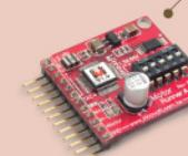
Motor Runner A 為直流馬達控制模組，可由 BASIC Commander® 透過簡易的指令設定，自由操控一顆直流馬達。可隨時動態的更改馬達轉速，並取得馬達現在的狀態，包含轉速或是方向。最大可以承受達 1.3A 與 35V 的電流電壓值。
