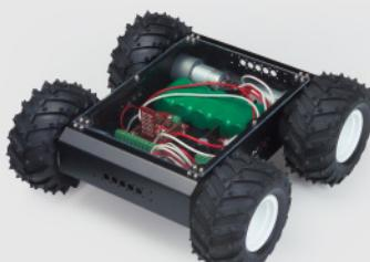
四輪越野輪型套件，包含四個直流馬達，直流馬達控制模組，鋁合金車身組件，以及BASIC Commander®。透過BASIC Commander®系統，非常容易整合週邊各種應用模組，例如加裝伺服機控制模組，控制機器手臂相關應用，或是加上超音波感測模組，增加障礙物迴避功能，豐富的擴充性適合做各種輪型平台的研究。
