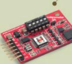
Accelerometer 3A 是一個加速度感測模組，可以量測XYZ三個軸向，靜態與動態的加速度值。由BASIC Commander® 下達感測指令，能回傳數位加速度值，並可動態設定四種感度，各軸向最大偵測值可達正負6g。
