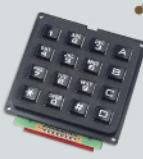
Keypad A 是一個4x4的鍵盤模組，可由 BASIC Commander® 透過 cmdBUS™ 直接操控。具有多種輸入模式，亦可自訂各鍵之設定回傳值。另可自訂去彈跳 (debounce) 時間，也可以設定自動重複輸入 (auto-repeat) 時間，讓按鍵久按時重複產生輸入。
