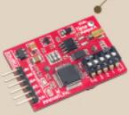
Time Keeper A 模組提供多樣的計時與鬧鈴功能。除了當地時間與日期。另提供第二時間可供設定，以及五個額外的倒數計時器。經由微調設定，每天時間誤差在0.08秒內。
