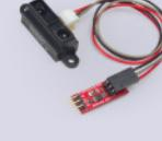
IRF80是利用SHARP GP2D12反射式紅外線偵測元件，來偵測從平面反射回來的類比訊號，並可透過A2P Converter轉換成脈波寬度訊號輸出，可測量約10-80cm之距離，使用者可依據不同環境進行調整。
