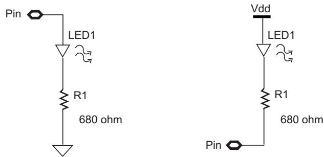
圖 6-4 LED的電路
