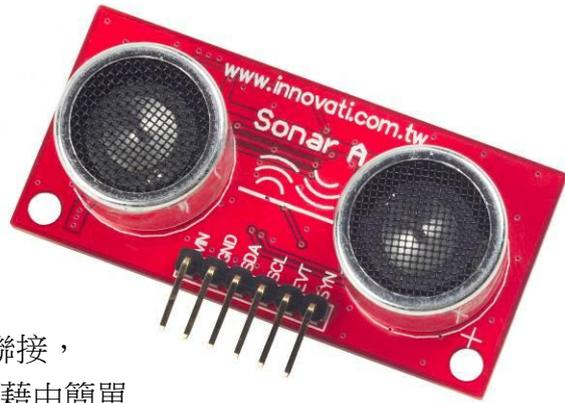
產品介紹：Sonar A 模組可透過簡單的聯接，直接由利基之 Arminno 操控各項應用，藉由簡單的指令下達設定環境的條件，配合所須的偵測次數，測量距離。
