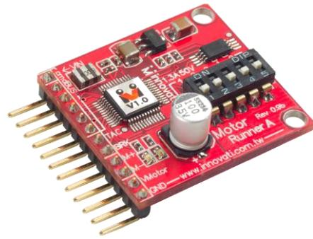
**產品介紹:** 利基 Motor Runner A 模組可以達到透過簡易的指令設定，自由操控單顆直流馬達的需求。可以隨時動態的更改馬達轉速，並取得馬達現在的設定狀態包含轉速或是方向。另外也提供 PID 參數可以控制馬達轉速。
