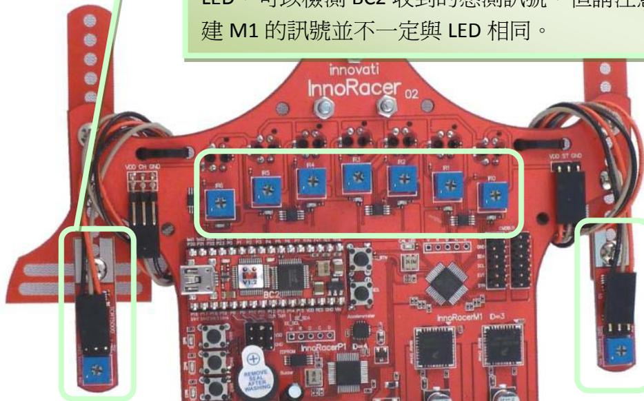
左方與右方的紅外線感測器，可以偵測到軌道外圍的路線資訊，中間的七個紅外線感測器，則是軌道偵測，每個紅外線感測器下方，都會有一個紅色 LED，可以檢測 BC2 收到的感測訊號，但請注意內建 M1 的訊號並不一定與 LED 相同。
