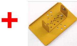
最後以軸承固定 Part F 於最下方的伺服機鋁板，就可以完成左腳框架，請再檢查所完成的左腳框架，是否與圖中結構相同
